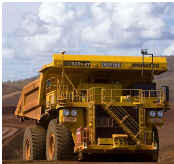
ダンプトラック930E (積載量約300t)
