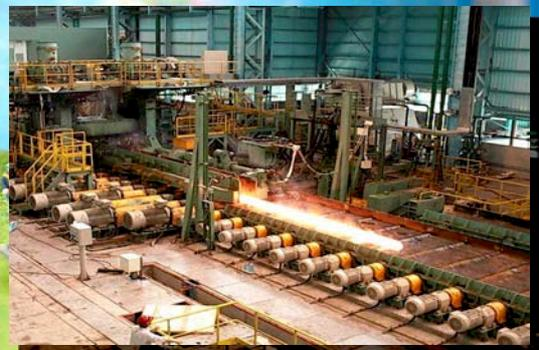
鉄鋼プラントの圧延工程
